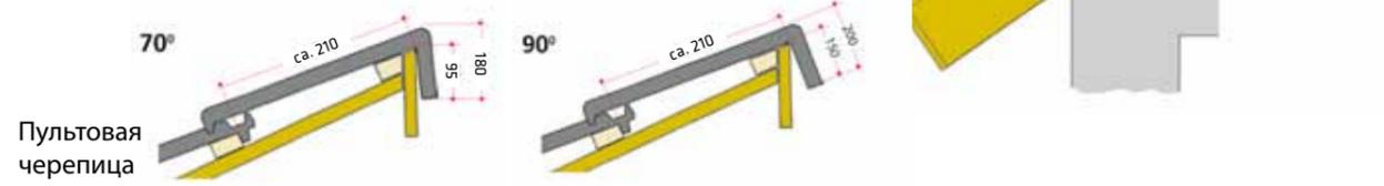
Карниз с глубоко посаженным водосточным желобом, конек с уплотнительной лентой.
