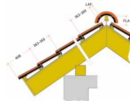
Карниз с глубоко посаженным водосточным желобом, конек с уплотнительной лентой.
